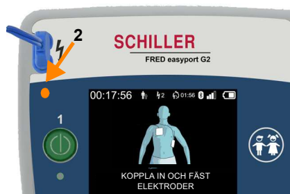
Bild 4.7 Placera ut vuxenelektrodena
